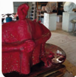
Aplicació de la cera a la superfície interior d'un dels dos motlles.
