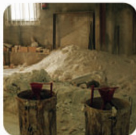
Fragmentació i introducció en cilindres amb sorra refractària.
